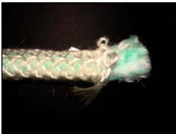
Cobertura de fibra de vidrio
