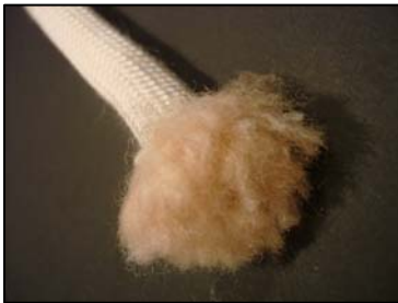
Cobertura de acrílico
