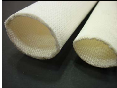
Machine circulaire de trame avec insertion interne et externe du tissu. Avec cape intermédiaire de polyéthylène.
