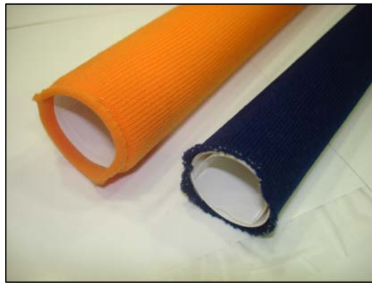
Machine circulaire de trame avec insertion interne et externe du tissu. Avec cape intermédiaire de polyéthylène.
