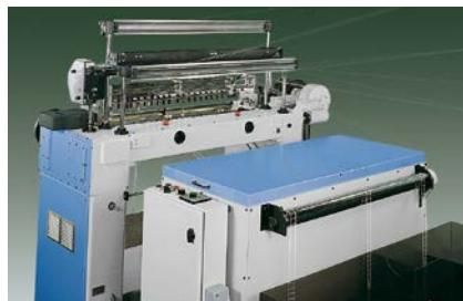
Machine à crochet électronique à haut rendement spécialement conçue pour la fabrication "d'échelettes" pour l'application en persiennes vénitiennes (ruban échelonné).
