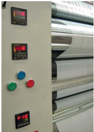
Système module de coupage et étirage de fil de polyéthylène, pour l'alimentation des machines Raschel, crochet et circulaires de chaîne.
